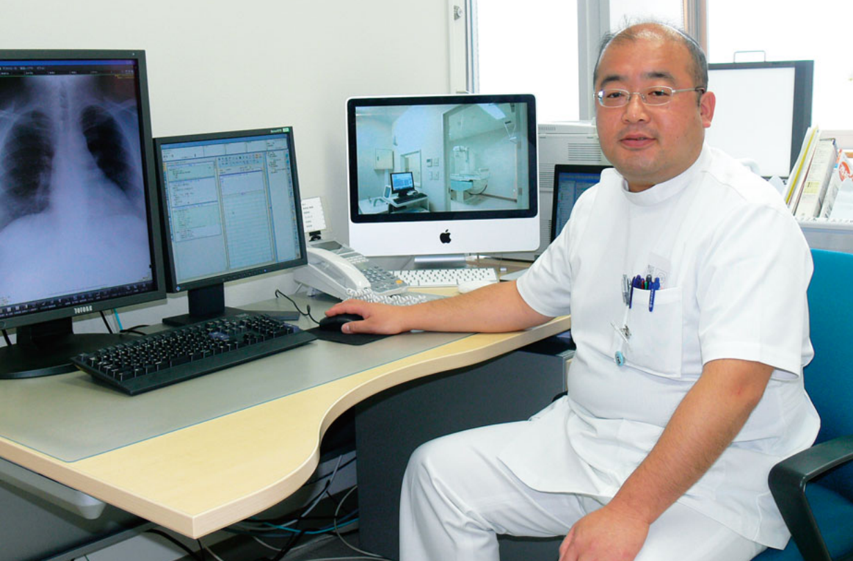
左から2番目が電子カルテのモニタ。いちばん左の画像診断用高精細モニタとも連動。画像をマウス操作で電子カルテに貼りつけることもできる。写真は鈴木一裕院長
