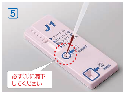
⑤ ④の処理検体20 \mu L(ワンプッシュ分)をミニピペットで取り、反応カセット①(処理検体)の凹みに滴下します。 *処理検体が吸い込まれない場合は、指で数回軽くたたいてください。
